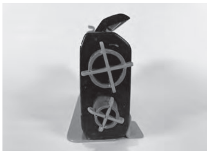
写真⑳ ダイヤルに取り付けられた自助具と転倒防止のための板
