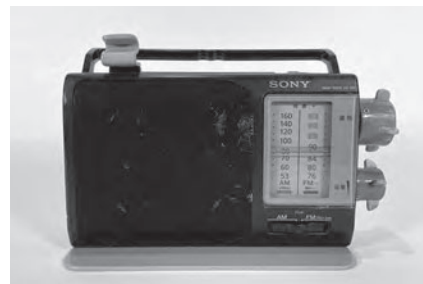
写真②⑥ 自助具付きラジオ [縦10.5×横24.5×高さ16.0cm 942g]
