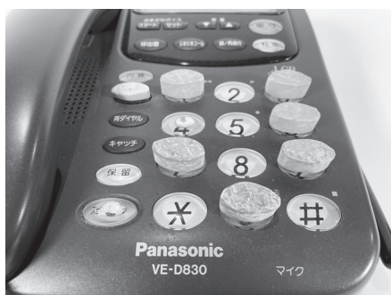
写真⑱ 電話機のボタンに貼り付けられた突起状の自助具
